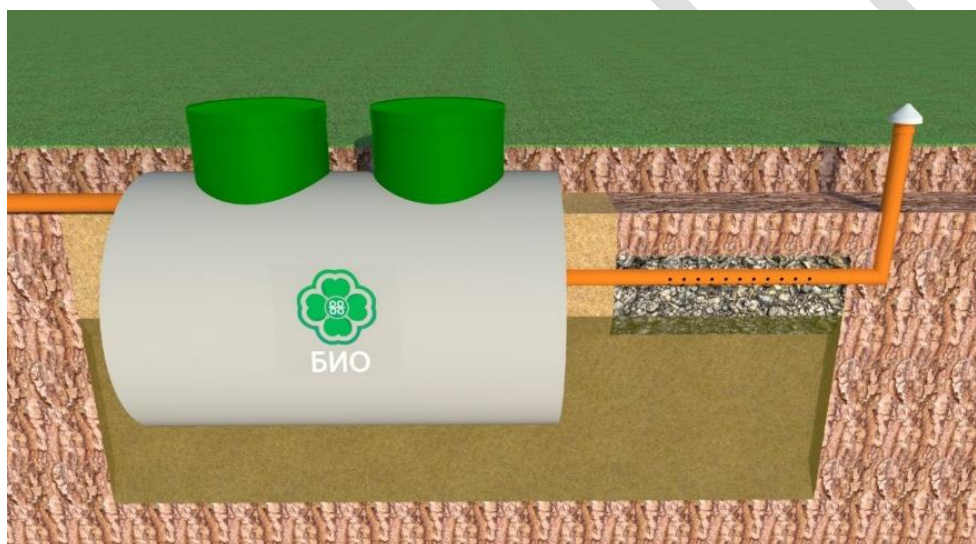
Рис.9.2. Для глинистых грунтов и при низком уровне грунтовых вод 1 м. и ниже
