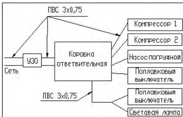
**16. СХЕМА ЭЛЕКТРИЧЕСКАЯ ПРИНЦИПАЛЬНАЯ ДЛЯ КОМПРЕССОРА DUO**
